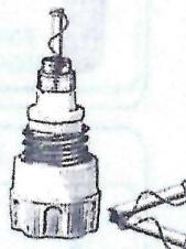
применять в аппаратах защиты электросетей некалиброванные плавкие вставки (скрутки проволоки, "жучки")
